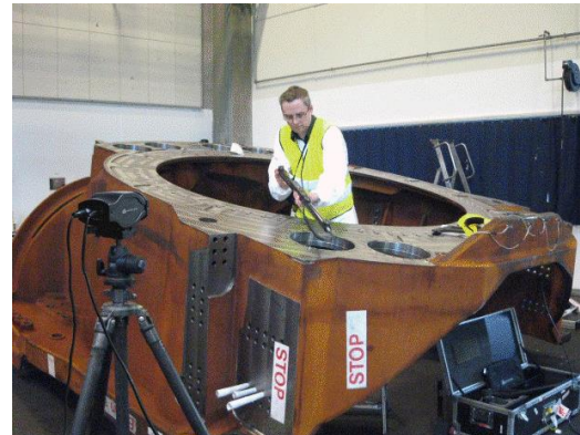
Mehrkamerantastung durch Vorwärtseinschneiden
