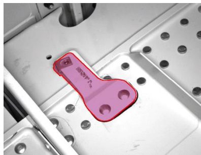
Vollständigkeitskontrolle im Flugzeugbau (Premium AEROTEC) links: Montage i.O.; Mitte: fehlerhafte Position; rechts: fehlendes Teil
