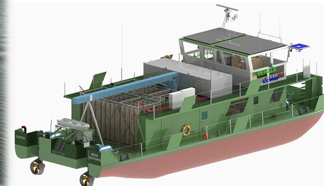
ELEKTRA mittels gasförmigen Wasserstoff, Brennstoffzellen und Akkumulatoren emissionsfrei unterwegs (Quelle: Behala / Binnenschiffahrt Online )
