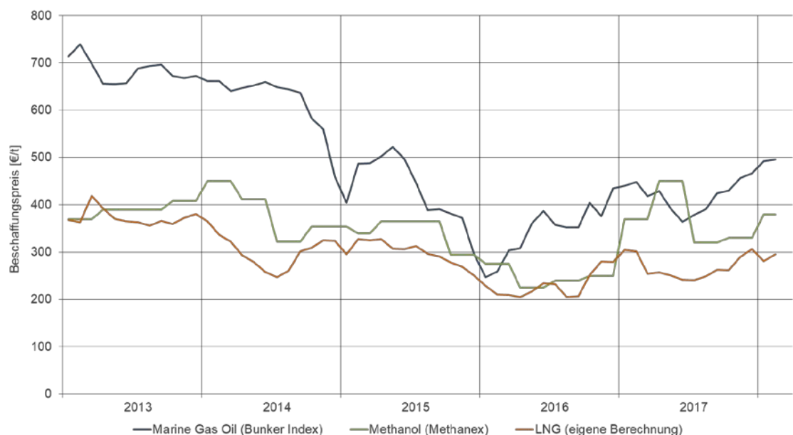
Abb. 5 | Preisentwicklung Marine Gas Oil, Methanol, LNG [€/t] [BI 2018, MX 2018, eigene Berechnung]
