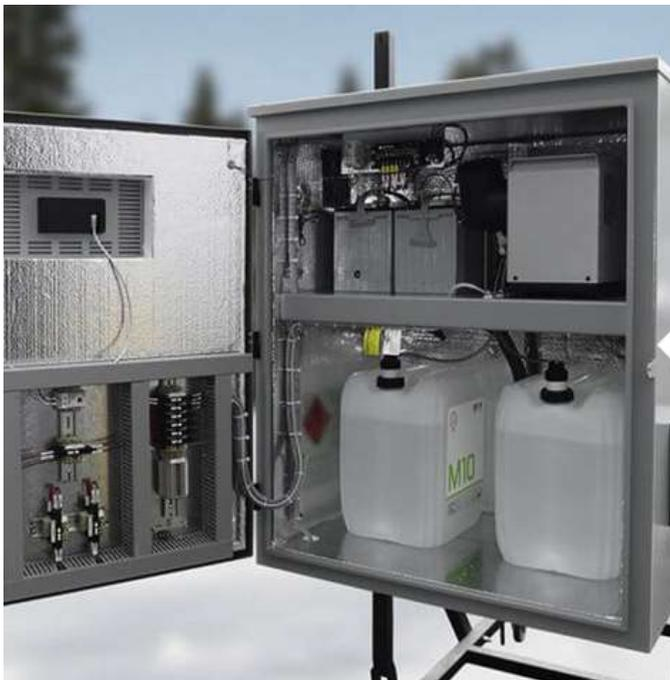
„Als Brennstoff dient bei der DMFC Methanol, das – anders als bei der indirekten Methanolbrennstoffzelle ohne vorherige Reformierung – zusammen mit Wasser der Anode zugeführt und dort oxidiert wird“
