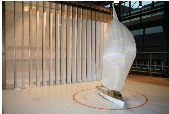
Segelyacht im Windkanal der FH Kiel
