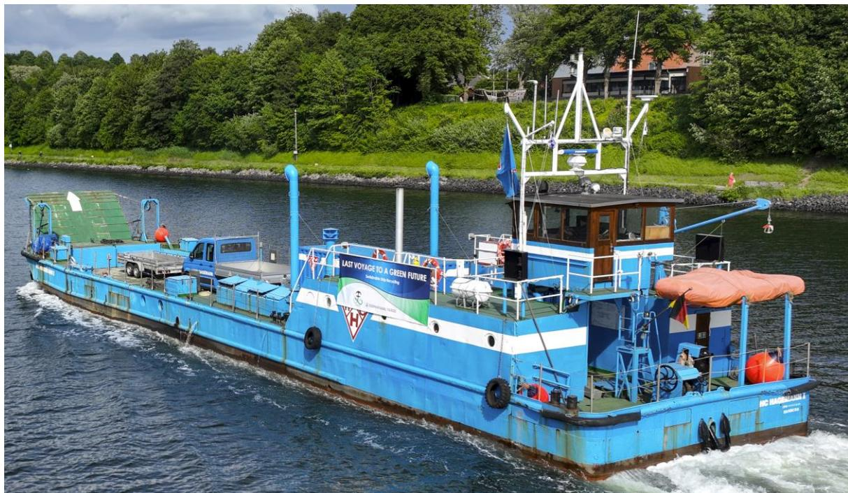
Die Leviathan GmbH empfängt ihr erstes Schiff zum nachhaltigen Recycling in Deutschland. Das Wasserbauschiff HC HAGEMANN 1 erreichte am Dienstag, den 14.6.2022, das Kieler Werftgelände der GERMAN NAVAL YARDS, wo Leviathan das Schiff in den kommenden Wochen mit einem kalten Schneidverfahren zerschneidet. Heute wurde das Schiff aus dem Wasser gehoben, da das weitere Recyclingverfahren an Land unter Beachtung höchster Umwelt- und Arbeitsschutzstandards durchgeführt wird.
